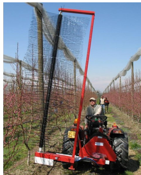
Fig. 1. Macchina diradante Darwin 300 (Fruit-Tec, Germania).
